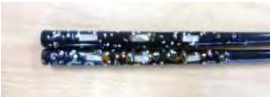
箸の表面は、水で濡らした砥石 → 水で濡らした耐水ペーパー → コンパウンドを塗ったウエスの順で磨いていきます。
